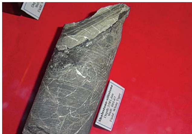
Hình 10. Cát kết Oligocen dưới bị nứt nẻ mạnh, nứt nẻ lấp đầy khoáng vật thứ sinh mỏ Bạch Hổ
