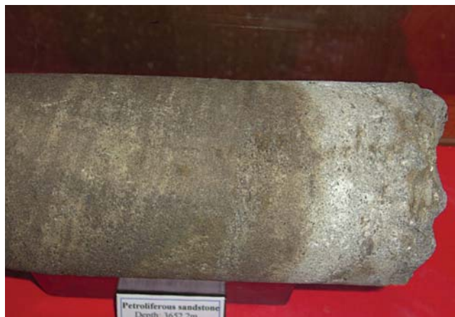
Hình 7. Đặc tính xâm nhiễm dầu không đều trong đá chứa Oligocen mỏ Bạch Hổ
