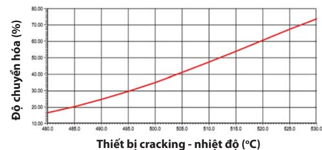
Hình 7. Ảnh hưởng của nhiệt độ tới độ chuyển hóa phản ứng cracking EDC
