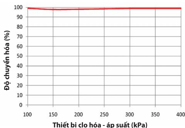
Hình 4. Ảnh hưởng của áp suất đến độ chuyển hóa của phản ứng oxy clo hóa
