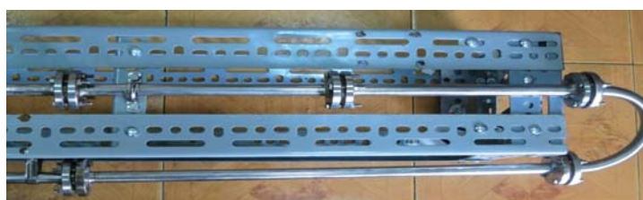
Hình 5. Thiết bị static mixer gồm các module nối tiếp nhau
